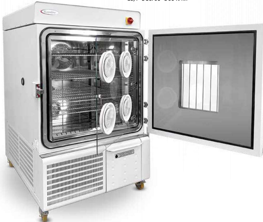
Klimakammer mit entnehmbarer Zwischenglastür und IRIS-Port-Eingriffen
